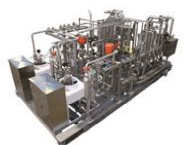
Unité de production d'azote à membranes - Arabie saoudite
